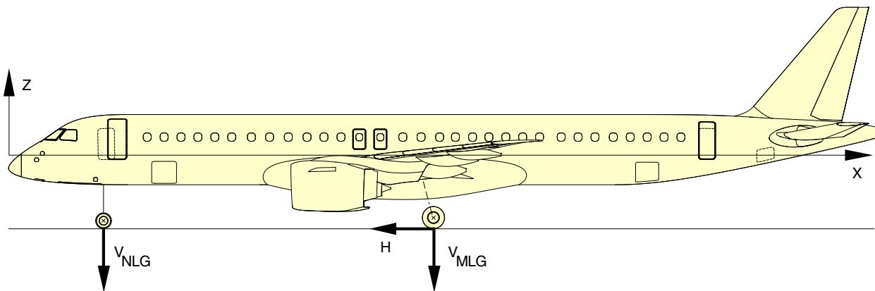
**NOTES: STEADY BRAKING:**  $H = 0.31 \cdot V_{MLG}$
