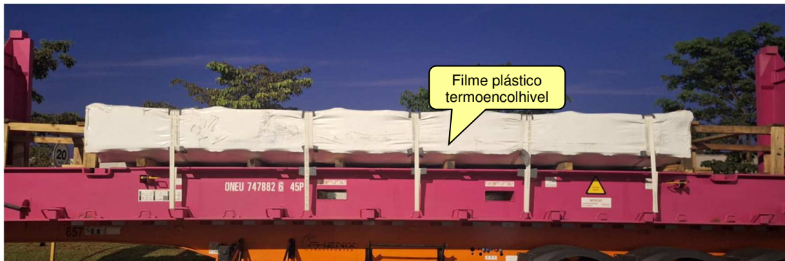
Figura 39-E: Exemplo de proteção plástica sobre palete em flat rack (protetive white shrink film)
