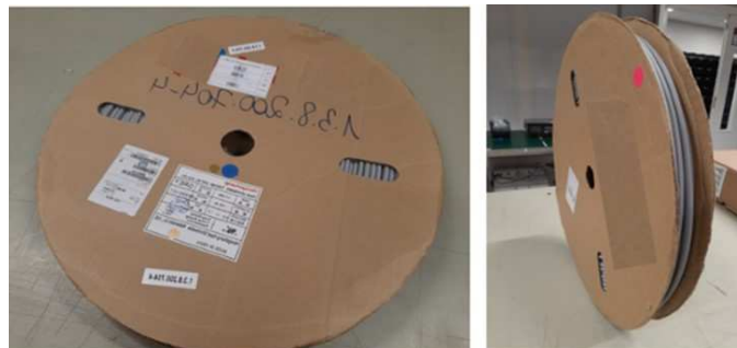
Figura 45-G: Exemplo Bobina de termo restringente
