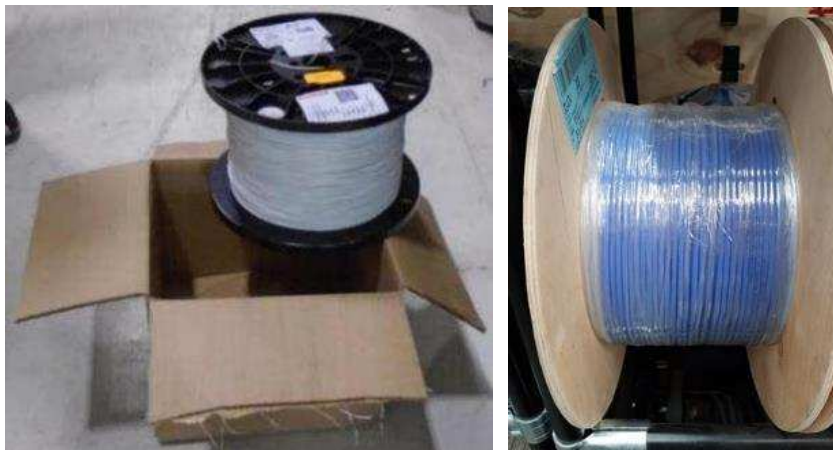
Figura 45-A: Bobina de fio colocada na caixa e com proteção primária
