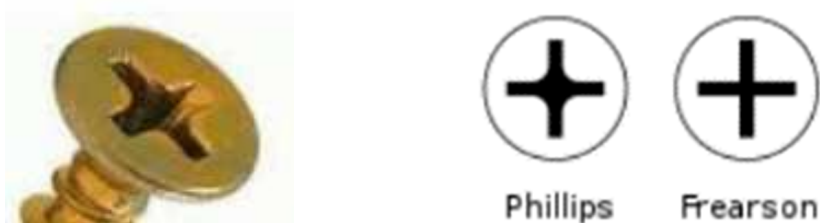
Figura 05-A: Parafuso com fenda Phillips ou Frearson
