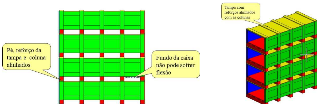
Figura 44-C: Exemplo de caixa Boa (colunas alinhadas)
