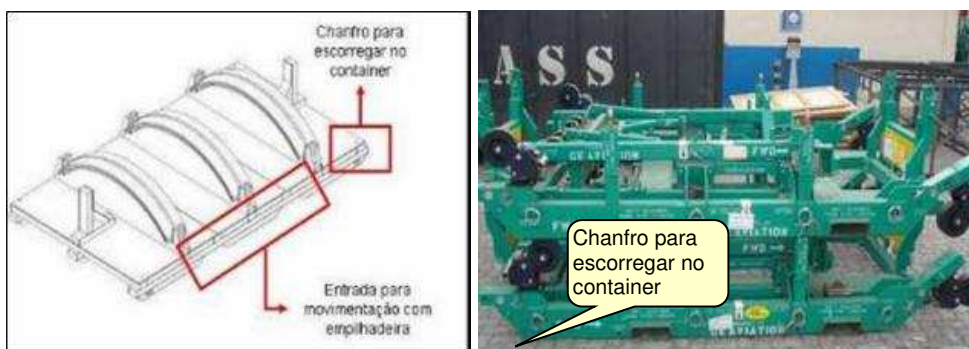
Figura 17: Exemplo de base de embalagem para uso em container fechado
