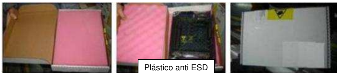
Figura 49: Exemplo de tens embalado individualmente com plástico anti-ESD
