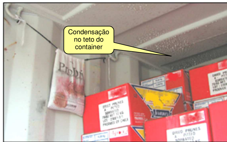
Figura 39-A – Umidade condensada no container
