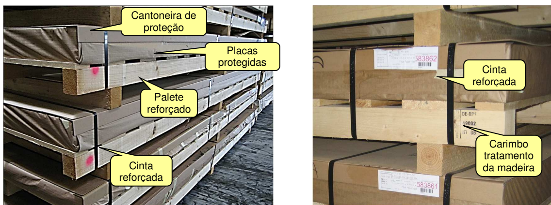
Figura 39-B: Exemplo de material paletizado utilizando cintas para amarração
