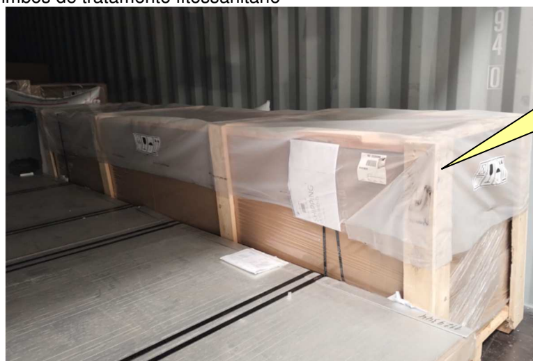
Fig 39-H: EXEMPLO de caixa protegida dentro do container
