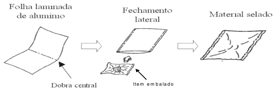
Figura 47: Exemplo de proteções eletromagnética
