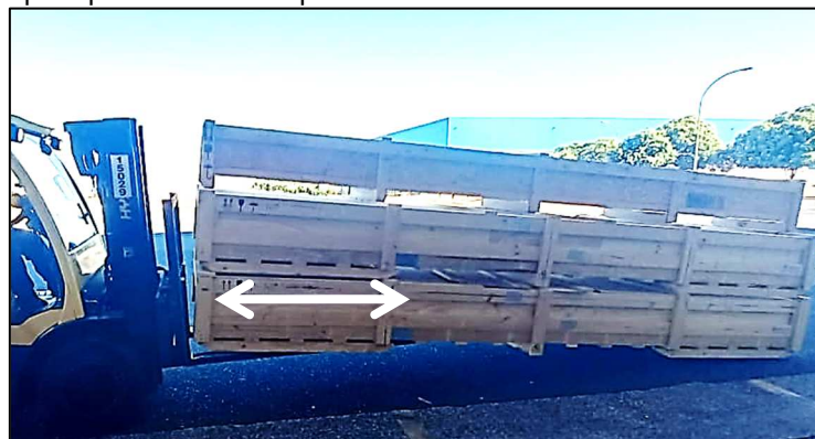
Figura 58-F: Caixa de madeira empurrada para dentro do container
