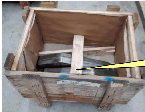
Figura 44-A: Travamento interno de item forjado
