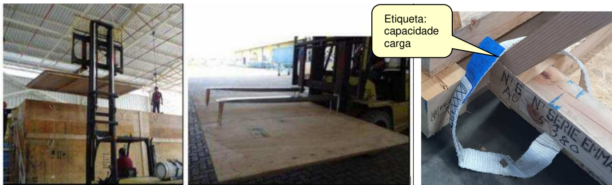
Figura 25: Exemplo de alças para facilitar manuseio de partes de tampa. Alça com etiqueta de capacidade
