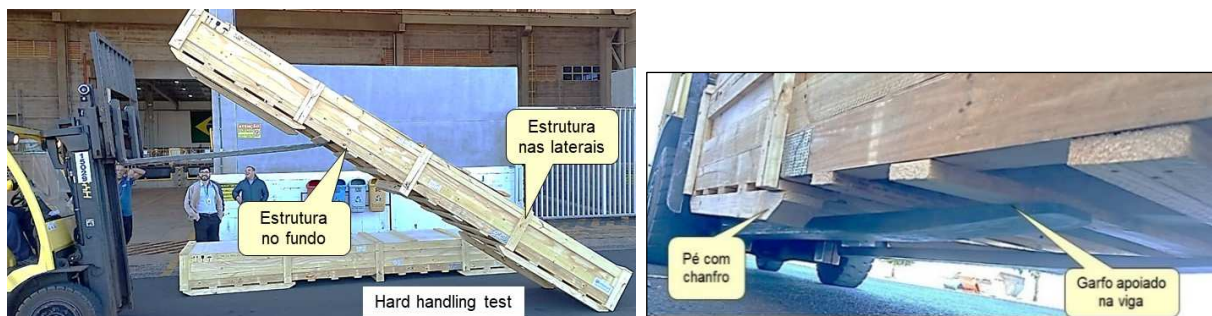
Figura 58-H: Exemplo caixa de madeira para grandes painéis ( garfo nunca encosta no fundo caixa )
