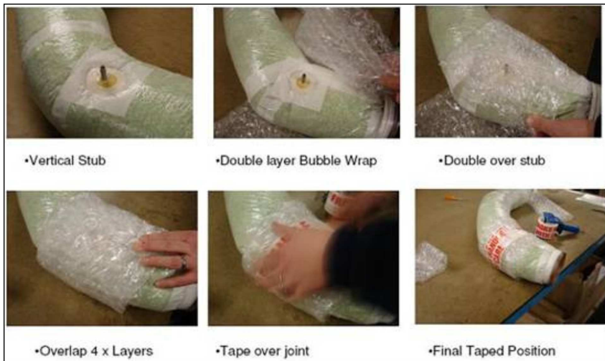
Figura 73: Exemplo de proteção de aresta no tubo
