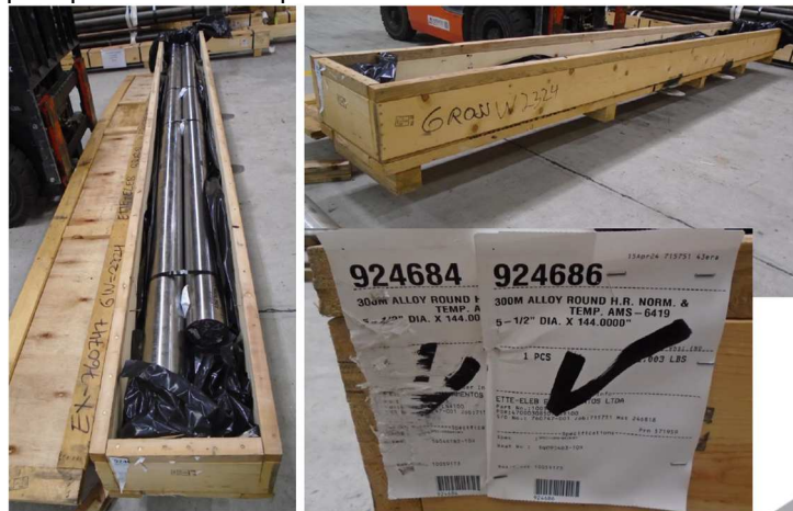
Fig 39-G: Exemplo de Barra redonda em caixa reforçada
