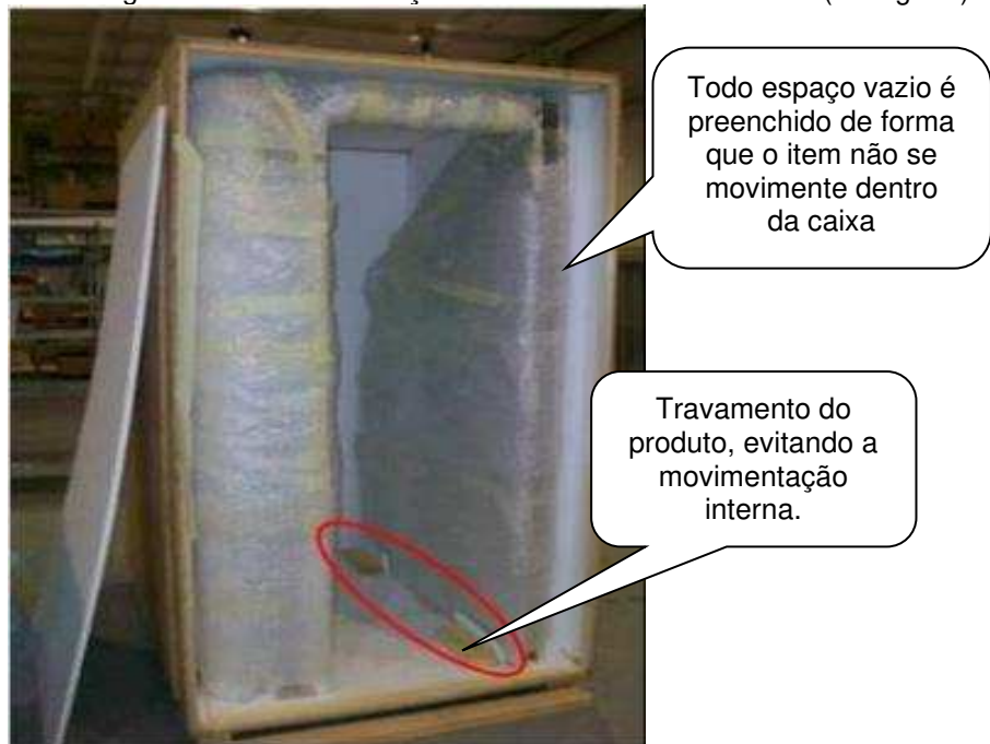
Figura 54: Exemplo de Itens com proteção individual
